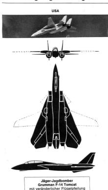
2 Düsentriebwerke Spannweite 10,1 bis 19,5 m V max. 2650 km/h Länge 18,8 m
