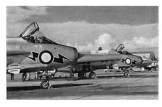
geschwindigkeit von Mach 3. Die Reichweite der 3,5 m langen Red Top liegt bei maximal 11 km.
