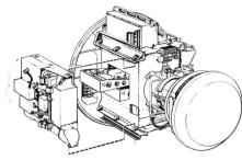
Dank dem auf dem vorerwähnten Radargerät basierenden Zielsuch- und Verfolgungssystem ist die JA 37 in der Lage, selbständig und ohne Hilfe eines Führungssystems am Boden den Feind zu suchen, zu jagen und zu vernichten. Dies kommt der Jägerversion des Viggen besonders beim Kampf gegen Tiefflieger zugute oder wenn das eigene erdgebundene Frühwarn- und Füh-
