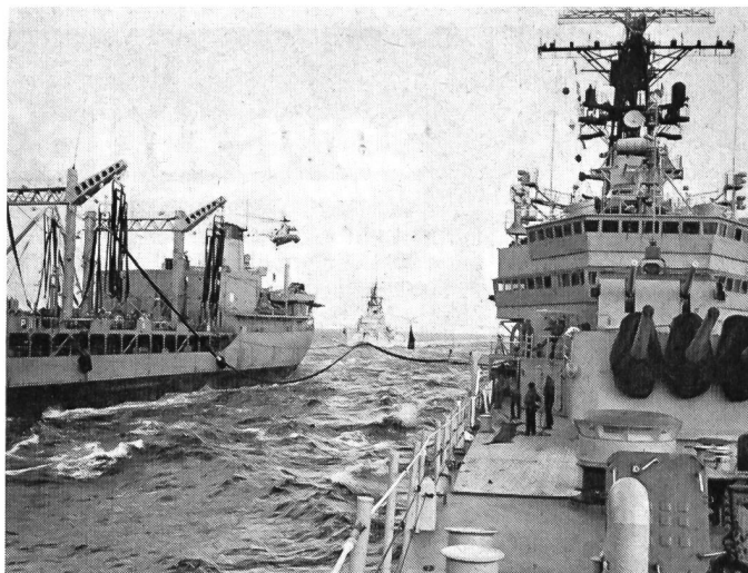
Underway Replenishment. Der Tanker «Neosho» der 6. Flotte hat Leinenverbindungen mit dem Flaggschiff, dem Kreuzer «Little Rock», hergestellt. Während Stunden fließt das kostbare Öl durch die Schlauchleitungen in die Bunker. Währenddessen setzt ein Sea-King-Helikopter einen Matrosen auf dem Heck des Tankers ab, und der Zerstörer «USS Manley» schiebt Wache im Hintergrund. Beachte den schweren Drillingsturm der «Little Rock» mit 15,2-cm-Geschützen, den Zwillingsturm mit 12,7-cm-Rohren (wie auf der «New») und die zwei breiten Kommandodecks (das untere für den Flottenstab, das obere für das Schiffskommando).
