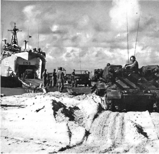
Ein Panzerlandungsschiff, die «USS Terrebonne Parish» (LST-1156), hat ihre Bugtore geöffnet und setzt eine Anzahl von Fahrzeugen der Task Force 62 über eine Pontonbrücke an Land. Vorne leichte Panzerfahrzeuge des Typs Onto, die je 6 Panzerabwehrrohre aufweisen (Kaliber 10,6 cm, dasselbe Rohr ist bei uns auf Jeeps montiert = BAT).
