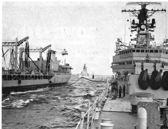
Underway Replenishment. Der Tanker «Neosho» der 6. Flotte hat Leinen- verbindungen mit dem Flaggschiff, dem Kreuzer «Little Rock», hergestellt. Während Stunden fließt das kostbare Öl durch die Schlauchleitungen in die Bunker. Währenddessen setzt ein Sea-King-Helikopter einen Matrosen auf dem Heck des Tankers ab, und der Zerstörer «USS Manley» schiebt Wache im Hintergrund. Beachte den schweren Drillingsturm der «Little Rock» mit 15,2-cm-Geschützen, den Zwillingturm mit 12,7-cm-Rohren (wie auf der «New») und die zwei breiten Kommandodecks (das untere für den Flottenstab, das obere für das Schiffskommando).
