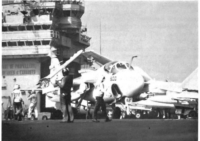
Eine Intruder A-6 B der Attack Squadron 34 rollt noch mit gefalteten Tragflächen zum Katapult. Über der mächtigen Radarnase ragt der Luftbetankungsstutzen heraus. Dahinter erhebt sich der siebenstöckige Kommandoturm, hinter der unteren Fensterreihe befindet sich die Flaggbücke (Admiralsdeck), darüber die Navigationsbrücke (eigentliche Kommandobrücke), und zuoberst ragt der Kontrollturm für die Flugoperationen heraus.
