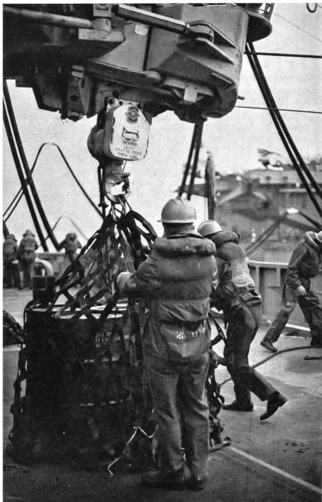
Inner in bunten Helmen und mit Schwimmweste befestigen die mit Gütern ladenen Netze an den Laufkatzen, die dann von der «Seattle» zur «Kendy» gefahren werden. Im Hintergrund sieht man diverse Ölleitungen.
