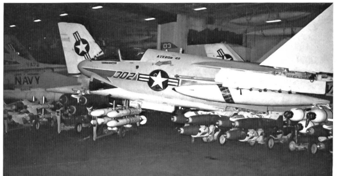
Im Hangardeck stehen dicht gedrängt eine Anzahl Maschinen, hier eine Corsair der Attack Squadron 46. Davor sind eine Menge kleiner Transportkarren mit diversen Bomben, Raketen und anderen Behältern zu sehen. Die Bewaffnung erfolgt meist oben auf dem Flugdeck, für alle Fälle werden die Zünder erst im allerletzten Moment eingeschraubt.
