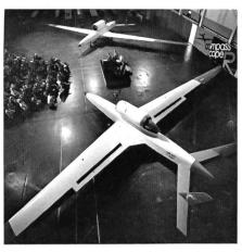
Bei Teledyne Ryan Aeronautical in San Diego fand der «Roll Out» der beiden im Rahmen des USAF Compass Cope Programmes entwickelten YQM-98-A-RPV-Prototypen statt. Die rund 6486 kg schweren Fernlenkflugzeuge sind für Dauerflüge (25 [+] Stunden) in Höhen von über 15 000 m ausgelegt. Der Antrieb erfolgt durch eine speziell für diese Version gebaute Strahlturbine Garrett AiResearch ATF-3 von 1837 kp Standschub. Dieser Turbofan verleiht dem YQM-98 A eine Reisegeschwin-
