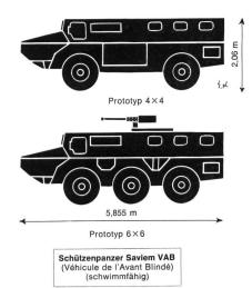
Baujahr 1973 Motor (Diesel) 245 PS Max. Geschw. 90 km/h
