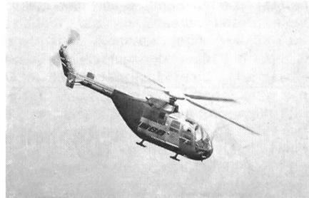
Eine mit einem verkleideten Rotorkopf, GfK-AGB-Rotorblättern (Advanced Geo-metry Blades), einem modifizierten Lande-work und einer strömungsgünstigeren Zelle versehene Hochgeschwindigkeitsversion HGH (Hoch-Geschwindigkeits-Hubschrau-ber) der MBB BO-105 erreichte bei einem maximalen Fluggewicht von 2,3 t anlässlich von Bahneignungsflügen eine Ge-schwindigkeit von 327 km/h. Die Spitzen-geschwindigkeit der BO-105-Seriemaschi-nen liegt dagegen bei rund 270 km/h. ka
