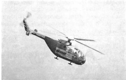
Eine mit einem verkleideten Rotorkopf, GfK-AGB-Rotorblättern (Advanced Geometry Blades), einem modifizierten Landewerk und einer strömungsgünstigeren Zelle versehene Hochgeschwindigkeitsversion HGH (Hoch-Geschwindigkeits-Hubschrauber) der MBB BO-105 erreichte bei einem maximalen Fluggewicht von 2,3 t anlässlich von Bahneignungsflügen eine Geschwindigkeit von 327 km/h. Die Spitzen geschwindigkeit der BO-105-Seriemaschinen liegt dagegen bei rund 270 km/h. ka
