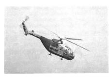
Eine mit einem verkleideten Rotorkopf, GfK-AGB-Rotorblättern (Advanced Geometry Blades), einem modifizierten Landewerk und einer strömungsgünstigeren Zelle versehene Hochgeschwindigkeitsversion HGH (Hoch-Geschwindigkeits-Hubschrauber) der MBB BO-105 erreichte bei einem maximalen Fluggewicht von 2,3 t anlässlich von Bahneignungsflügen eine Geschwindigkeit von 327 km/h. Die Spitzengeschwindigkeit der BO-105-Seriemaschinen liegt dagegen bei rund 270 km/h. ka
