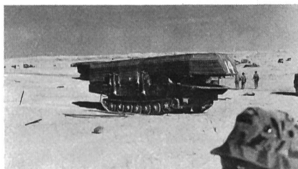
Sowjetisches Brückenbaugerät auf PT-76-Schwimmpanzer-Fahrgestell.
