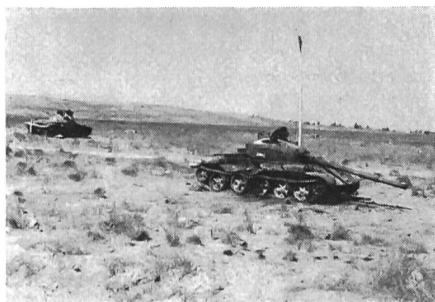
Sowjetischer Panzer T-62. Dieser Kampfpanzer ist mit einer 115-mm-Kanone ausgerüstet, die zwei Munitionsarten verschiessen kann: APFSDS (Armor Piercing, Fin-Stabilized, Discarding Sabot = Flügelstabilisiertes Wuchtgeschoss mit Treibspiegel) und HEAFS (High Explosive, Antitank, Fin-Stabilized = Flügelstabilisiertes Hohlladungsgeschoss)
