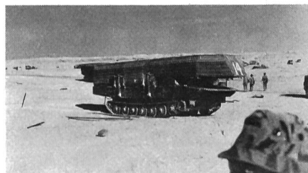
Sowjetisches Brückenbaugerät auf PT-76-Schwimmpanzer-Fahrgestell.
