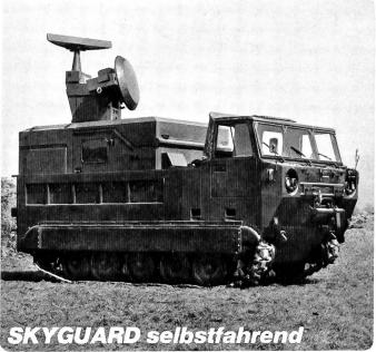
Pulsdoppler Suchradar mit autom. Zielalarm Monopulsdoppler Präzisions-Zielfolgeradar **Automatisches TV-Tracking** Miniaturisierter,
