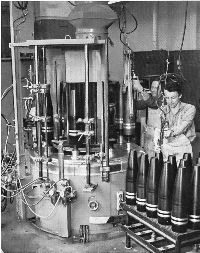
Oberflächenbehandeln von schweren Artillerie-Geschosskörpern (M+FA)
