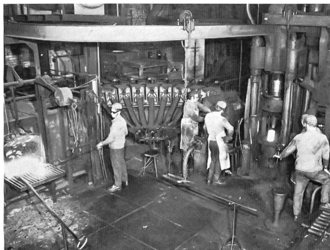
Mit hydraulischen Pressen werden die glühenden Stahlrugel geformt. (M+FA)
