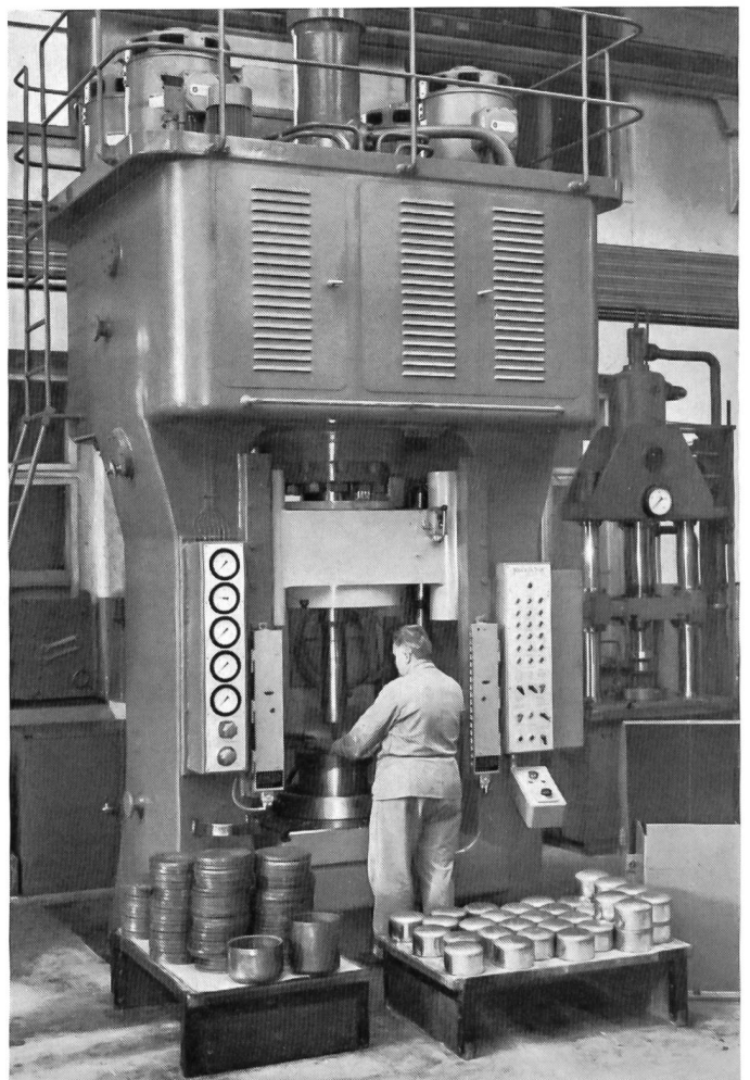
Oberflächenbehandeln von schweren Artillerie-Geschosskörpern (M+FA)
