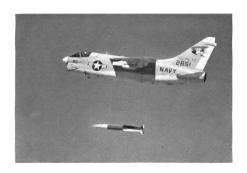
digkeit von über Mach 1,9 beschleunigt. Danach übernimmt der Staustrahlmotor mit dem ausgebrannten Gehäuse des Raketenmotors als Brennkammer den Antrieb des Flugkörpers. Als mög-liches Leistungspotential des Low Volume RamJet werden Geschwindigkeiten bis Mach 4 und Reich-weiten von 370-555 km genannt.
