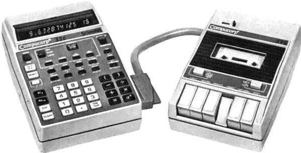
Mit diesem neuen Computer-System haben Sie – wo und wann immer Sie wollen – sämtliche Arbeitsprogramme zur Hand. Über 120 000 Programmschritte, 9000 Datenspeicher (in einer Magnetbandkassette gespeichert), 14 logische Entscheide mit 6 verschachtelten Subroutinen, 13 symbolischen Adressen, über 50 problemorientierte Funktionen, 4 Klammern mit gleichzeitiger separater Anzeige, direkte Umformungen usw.
