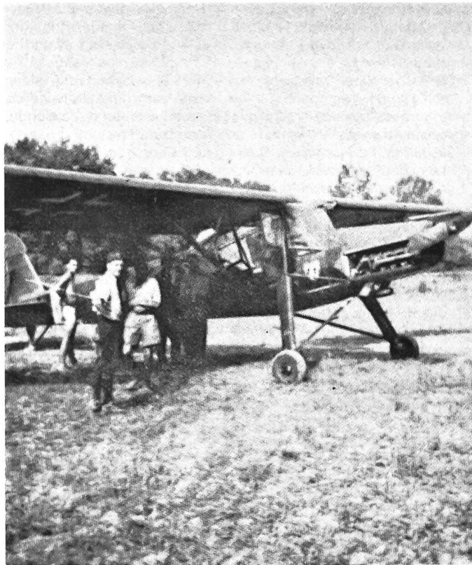
Deutsches Leichtflugzeug vom Typ Fieseler Storch. Es bietet Platz für einen oder zwei liegend zu transportierende Verwundete.
