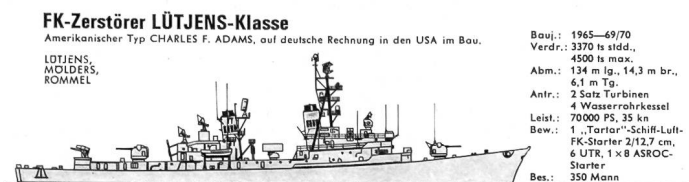
Seitenrisssskizze der neuen Flugkörper-Zerstörer der Bundesmarine mit den nötigen technischen Daten.
