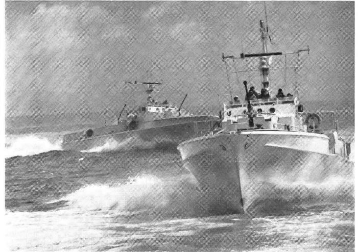
Deutsche Schnellboote vom Typ Jaguar auf dem Marsch. Sie sind mit zwei 40-mm-Kanonen und vier Torpedorohren bewaffnet und verdrängen 160 t. Die Besatzung ist 39 Mann stark, und die Motoren leisten 12 000 PS.
