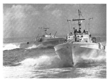
Deutsche Schnellboote vom Typ Jaguar auf dem Marsch. Sie sind mit zwei 40-mm-Kanonen und vier Torpedorohren bewaffnet und verdrängen 160 t. Die Besatzung ist 39 Mann stark, und die Motoren leisten 12 000 PS.
