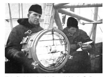
Mit dem Signalscheinwerfer auf der Kommandobrücke eines Zerstörers werden Befehle und Nachrichten von Schiff zu Schiff gegeben. Dies ist nach wie vor auch im Zeichen von modernen Funkmitteln nötig.
