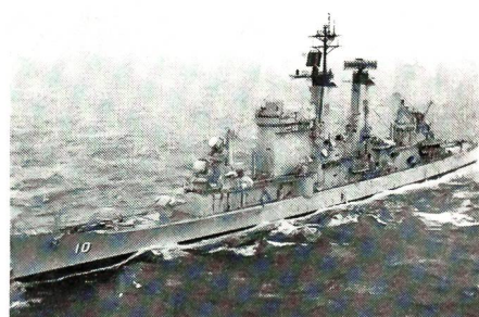
Der Raketenkreuzer «USS Albany» auf voller Fahrt im Mittelmeer. Er verdrängt maximal 18 000 t, ist 205 m lang, läuft 33 Knoten und verfügt über zwei 12,7-cm-Geschütze, zwei Doppelstarter für Talos- und zwei Doppelstarter für Tartar-Lenk Waffen, sechs Torpedorohre und einen Achtfachwerfer für Anti-U-Boot-Raketen.
