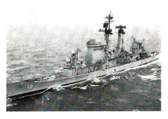
Der Raketenkreuzer «USS Albany» auf voller Fahrt im Mittelmeer. Er verdrängt maximal 18 000 t, ist 205 m lang, läuft 33 Knoten und verfügt über zwei 12,7-cm-Geschütze, zwei Doppelstarter für Talosund zwei Doppelstarter für Tartar-Lenkwaffen, sechs Torpedorohre und einen Achtfachwerfer für Anti-U-Boot-Raketen.
