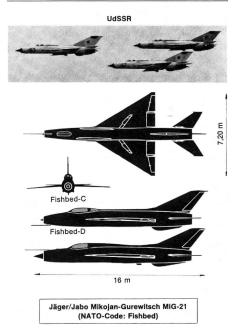
1 Düsentriebwerk 2 Kan 23 mm, Bb, Rak V max. 2250 km/h Alle WAPA-Staaten
