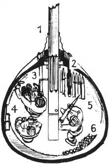
Kampfraum eines T-54/55-Panzers: 1 Kampf-wagenkanone, 2 Turm-Mg, 3 Zielfernrohr, 4 Funkgerät, 5 und 6 Munition
