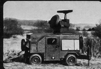
**Luftraumüberwachungs- und Feuerleitsystem
