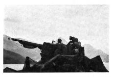
Zur Ausrüstung der Flugplatzflabbatterien gehört diese vollradarisierte 35-mm-Zwillingskanone mit einer Kadenz von 1100 Schuss/Minute.
