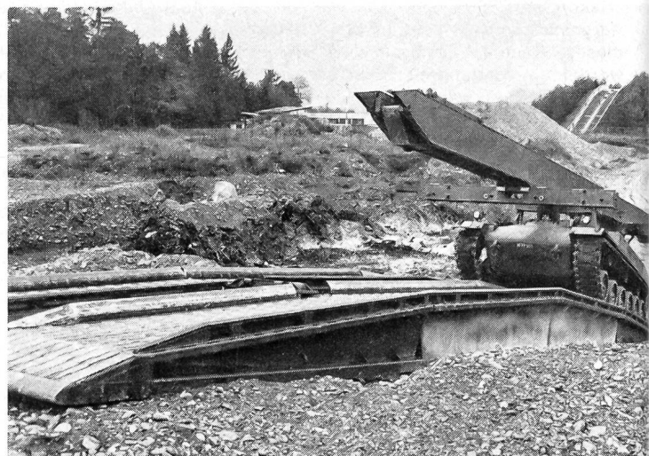
Der Panzer fährt über die eigene Brücke. Er ist genau gleich aufgebaut wie der Pz 68, trägt aber anstelle des Turmes die Brücke. Gesamtgewicht: 45 t. Fahrgeschwindigkeit: 50—55 km/h.
