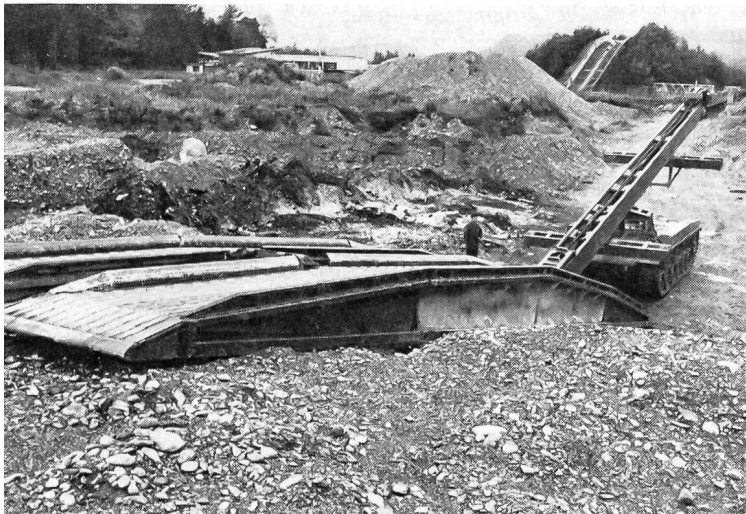
Der Br 68 legt die Brücke auf den Boden und fährt sofort in die nächste Deckung. Es können Hindernisse nach oben oder unten oder Gräben bis 18 m überbrückt werden. Die Brücke ist so konzipiert, dass jedes Militärfahrzeug vom Pz 55/57 (Centurion) bis zum kleinen Puch-Haflinger übersetzen kann. Belastungsgrenze: 50 t, ausnahmsweise bis 60 t.
