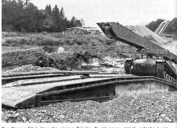
Der Panzer fährt über die eigene Brücke. Er ist genau gleich aufgebaut wie der Pz 68, trägt aber anstelle des Turmes die Brücke. Gesamtgewicht: 45 t. Fahrgeschwindigkeit: 50—55 km/h.
