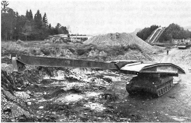
Der neue Schweizer Brückenlegepanzer 68 beim Auslegen der Brücke. In der Mitte der zweiteiligen Spürträgerbrücke liegt der Auslegemechanismus, bestehend aus dem Führungsrahmen, dem Fühler, dem Schiebewagen und der Brückenarretierung. Im Bild tastet der Fühler nach der Unterlage. Das Auslegen besorgt der Fahrer hydromechanisch in zwei Minuten.
