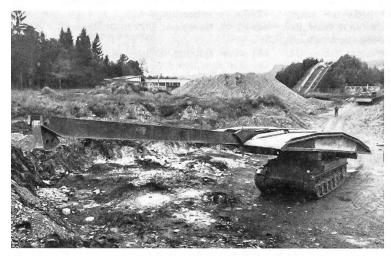
Der neue Schweizer Brückenlegepanzer 68 beim Auslegen der Brücke. In der Mitte der zweiteiligen Spurträgerbrücke liegt der Auslegemechanismus, bestehend aus dem Führungsrahmen, dem Fühler, dem Schiebewagen und der Brückenarretierung. Im Bild tastet der Fühler nach der Unterlage. Das Auslegen besorgt der Fahrer hydromechanisch in zwei Minuten.
