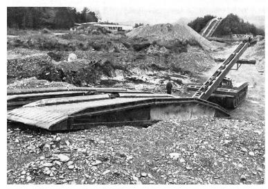
Der Brü Pz 68 legt die Brücke auf den Boden und fährt sofort in die nächste Deckung. Es können Hindernisse nach oben oder unten oder Gräben bis 18 m überbrückt werden. Die Brücke ist so konzipiert, dass jedes Militärfahrzeug vom Pz 55/57 (Centurion) bis zum kleinen Puch-Haflinger übersetzen kann. Belastungsgrenze: 50 t, ausnahmsweise bis 60 t.
