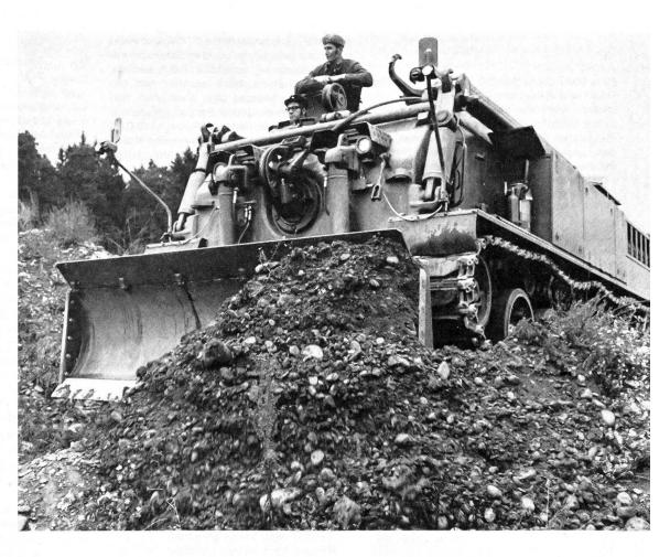
Der Bugkran erlaubt das Heben von Lasten bis 15 t mittels des Hauptwindenseils. Der Kran dient zum Austausch des Turms oder des Antriebsblocks. In Kästen sind die notwendigen Werkzeuge und die wichtigen Ersatzteile gelagert. Der Ent Pz 65 wiegt etwa 39 t; er entstand aus den Schweizer Panzern 61 und 68. Besatzung: ein Kommandant, ein Fahrer und drei Entpannungssoldaten.
