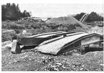
Die 7 t schwere Aluminiumbrücke liegt auf der vorderen Seite auf dem Boden. Anschliessend wird der Fühler zurückgezogen.
