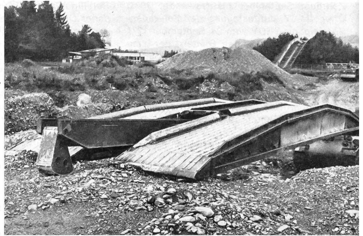
Die 7 t schwere Aluminiumbrücke liegt auf der vorderen Seite auf dem Boden. Anschliessend wird der Fühler zurückgezogen.
