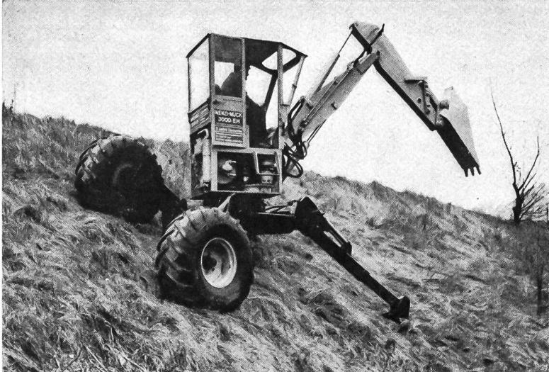
Der Bagger, der mehr leistet als die anderen, weil er nicht nur für die üblichen Baggerarbeiten eingesetzt werden kann, sondern auch im Steilhang und im Sumpf, wo bisher nur Handarbeit möglich war. Der MUCK hilft Arbeitskräfte sparen und Unkosten senken.
