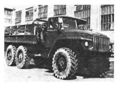
Die sowjetischen Ural-Automobilwerke haben zum 1. Mai 1973 den neuen «Ural»-Lastwagen herausgebracht. Er ist ausgerüstet mit einem Dieselmotor JAMS-740 der Motorenwerke Jaroslwal. Seine Tragfähigkeit beträgt 5 t, und er vermag Anhängerlasten von 7 t zu ziehen.
