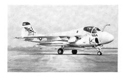
Unter dem Rumpf dieses zweisitzigen Allwetter-Tiefangriffsflugzeugs Grumman A-6 Intruder befindet sich ein Laser-Zielbeleuchtungssystem, das die Aeronutronic Division von Philco Ford im Rahmen eines 1,7-Millionen-Dollar-Auftrages für die US Navy fertigte. Das in einem Behälter untergebrachte «Laser Target Designator and Tracking»-System kann auch an den Flü-
