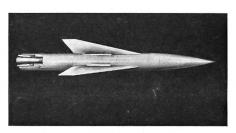
Die Lenkwaffe kann aus allen Fluglagen und -höhen verschossen werden. Einzige Auflage ist eine Minimalgeschwindigkeit von 450 km/h. Im Überschallbereich bestehen hingegen keinerlei Einschränkungen. Für die Lenkung dieses Flugkörpers wurde nachträglich ein halbautomatisches Führungssystem entwickelt, das sich nun bei den französischen Luftstreitkräften im Einsatz befindet. Neben Frankreich und der BRD haben auch Israel, die RAF, Südafrika und die Schweiz diese Rakete beschafft
