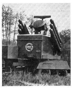
Das von der Contraves AG, Zürich, mit firmeneigenen Mitteln entwickelte Feuerleitgerät Skyguard wurde bekanntlich von Anfang an zur Steuerung von Geschützen und Lenkwaffen ausgelegt. In Le Bourget präsentierte nun die zur Bührle Holding AG gehörende Firma das autonome Lenkwaffensystem Skyguard M. Bestehend aus dem Feuerleitgerät Skyguard und einer Werfereinheit, handelt es sich dabei um ein hochmobiles, unabhängiges Allwetter-Lenkwaffensystem für die Bekämpfung von
