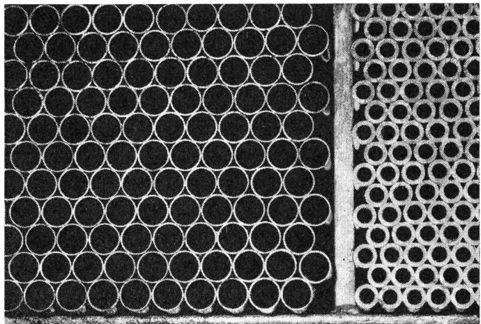
Präzisions-Stahlrohre, starkwandige Stahlrohre.
