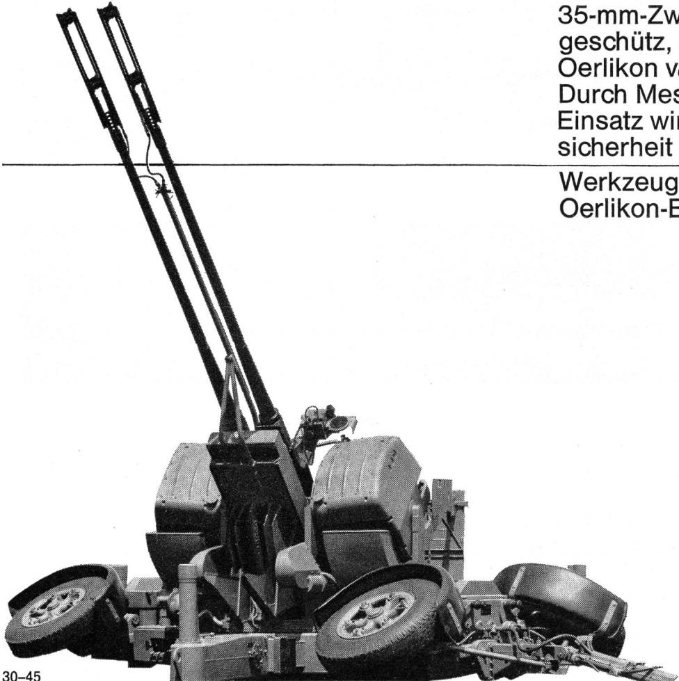
35-mm-Zwillings-Fliegerabwehr-geschütz, ausgerüstet mit einer Oerlikon  $v_0$ -Messeinrichtung.
