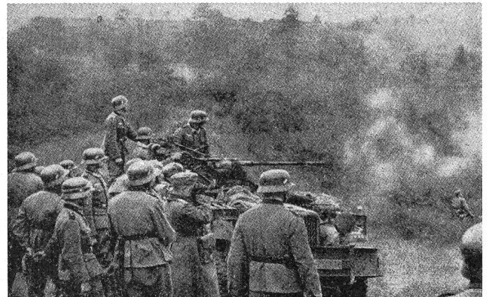
2-cm-Flakgeschütz auf Selbstfahrlafette. Fahrgestell: 1-t-Zugmaschine (Halb- kettenfahrzeug), ungepanzert, 70 PS, 40 km/h.
