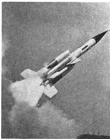
Eine Bloodhound kurz nach ihrem Start. Gut sichtbar sind die voll arbeitenden Starthilferaketen (Booster).
