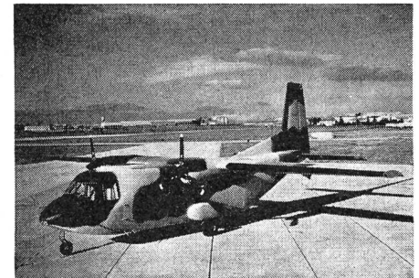
Die spanische Luftwaffe hat 50 STOL-Mehrzwecktransporter CASA C.212 Aviocar als Ersatz für ihre veralteten Frachter Ju 52 und C-47 bestellt. Die Aviocar besitzt eine Heckladetüre, die sich für Fallschirmabwürfe während des Fluges öffnen lässt. Neben zwei Mann Besatzung können 16 Luftlandesoldaten transportiert werden. Zurzeit fliegen zwei Prototypen, und die erste Lieferung von Serienflugzeugen ist für 1973 zu erwarten. K. A.
