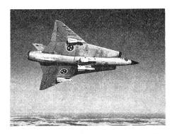
Eine Saab J-35 Draken, bestückt mit je zwei Luft-Luft-Lenkwaffen RB 27 und RB 28.
