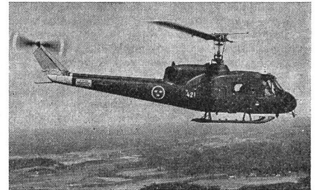
Der Transporthubschrauber Augusta Bell 204 B (schwedische Bezeichnung Hkp 3) erreicht eine Geschwindigkeit von 230 km/h und fasst neben zwei Mann Besatzung bis zu acht vollausgerüstete Soldaten.
