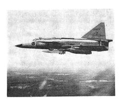
Die Saab AJ-37 Viggen, bestückt mit zwei Luft-Boden-Lenkwaffen RB 05 A und zwei Bofors-Werfern für je sechs ungelenkte 135-mm-Raketen.
