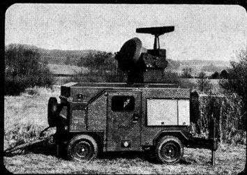
**Luftraumüberwachungs- und Feuerleitsystem
