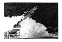
der Anflugphase eine Inertialplattform, und ein aktiver Radarzielsuchkopf sichert die Lenkung im Endanflug. Der 4,82 m lange und etwa 700 kg (Gefechtskopf 200 kg) schwere Flugkörper kann sowohl von Kriegsschiffen, Helikoptern und Starrflüglern als auch von der Küste aus verschossen werden, ohne dass grössere Modifikationen notwendig sind. Als Startrampe dient der Lager- und Transportcontainer.
