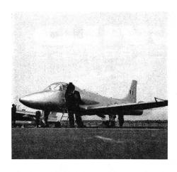
waffe die Vampire-Schulflugzeuge. Der Kiran wird von einer Rolls-Royce-Viper-II-Strahlturbine angetrieben und erreicht damit auf Meereshöhe eine Geschwindigkeit von 780 km/h.
