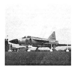
Das Mehrzweckkampfflugzeug AJ-37 Viggen der Firma Saab-Scania glänzte vor allem durch die hervorragenden Flugvorführungen des Testpiloten Henriksson. Bei den Landungen stach insbesondere auch die Schubumkehr beim Triebwerk RM 8 hervor. Eine Jagd- und eine Aufklärungsversion dieses STOL-Flugzeuges stehen gegenwärtig in Entwicklung.
