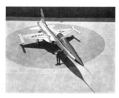
und zwei Luft-Luft-Lenkwaffen AIM-9 Sidewinder. Im weiteren besteht die Möglichkeit, an fünf externen Aufhängepunkten Abwurflasten bis zu einem Gesamtgewicht von 2812 kg mitzuführen.
