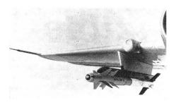
Die mit einem IR-Zielsuchkopf ausgerüstete Kurzstrecken - Luft - Luft - Lenkwaffe Matra R-550 Magic steht zurzeit in Flugerprobung. Diese Rakete soll ab 1973 die bei der französischen Luftwaffe und bei den Marineluftstreitkräften eingeführte amerikanische Sidewinder ablösen. Verschiedene weitere Streitkräfte interessieren sich für diesen französischen Entwurf.
