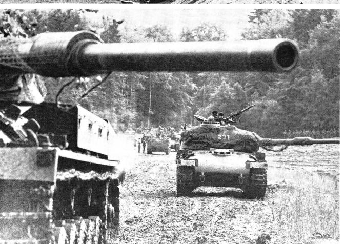
Dieses Ungetüm aus Stahl ist eine Eigenkonstruktion der Eidg. Konstruktionswerkstätten. Gewicht 37 t. Feuerkraft, Beweglichkeit, Geschwindigkeit und Wendigkeit zeichnen den Kampfpanzer 61 aus.
