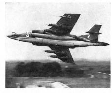
Das britische Tiefangriffsflugzeug Hawker Siddeley Buccaneer S.MK.2 mit vier Martel-Luft-Boden-Lenkwaffen. Von der Martel-Rakete gibt es eine Version mit Fernsehlenkung und eine mit Radarzielsuchkopf.
