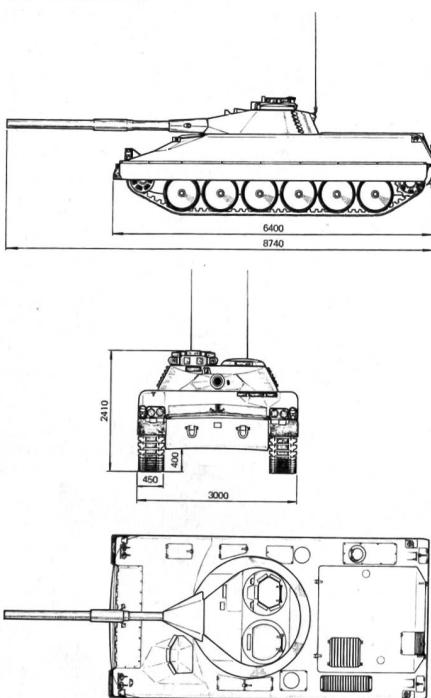
Das schwedische Heer erprobte gegenwärtig den Prototyp eines neuen vollamphibischen Leichtpanzers. Dieser wurde bei der Firma Hägglunds auf Grund eines offiziellen Pflichtenheftes entwickelt.
