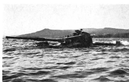
Um den Anforderungen des modernen Gefechtsfeldes gewachsen zu sein, ist der IKV 91 ferner mit einer ABC-Schutzanzug ausgerüstet, die u. a. dafür sorgt, dass im Innern des Fahrzeuges jederzeit ein leichter Überdruck herrscht.
