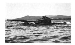
Geschütz können 68 Granaten mitgeführt werden. Rohrparallel ist ein 7,62-Mg eingebaut, und ein weiteres Gewehr des gleichen Typs kann man auf dem Turm montieren. Die Bewaffnung wird durch 12 Nebelwerfer ergänzt.
