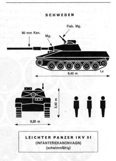
Baujahr 1970 (Prototyp) 1972 (Serie) Motor 330 PS Gewicht 15 t Max. Geschw. 67 km/h Land 8 km/h Wasser
