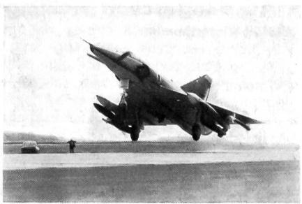
Gut ersichtlich sind die beiden einziehbaren Bugflügel und die Außenlast. Letztere besteht aus 5 Schweizer 450-kg-Bomben, 2 Sidewinder-Luft-Lenkwaffen und 2 500-Liter-Zusatztanks. Im weiteren umfasst die Bewaffnung 2 interne 30-mm-DEFA-Kanonen.
