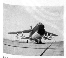
A-7 G, die Schweizer Version des Corsairs, mit einer typischen Erdkampfzuladung. Sie besteht aus zwei Sidewinder-Infrarot-Luft-Luft-Lenkwaffen, zehn 450-kg-Bomben und einer im Rumpf eingebauten 20-mm-Vulcan-Kanone M 61 mit 1000 Schuss Munition.
