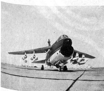
A-7 G, die Schweizer Version des Corsairs, mit einer typischen Erdkampfzuladung. Sie besteht aus zwei Sidewinder-Infrarot-Luft-Luft-Lenkwaffen, zehn 450-kg-Bomben und einer im Rumpf eingebauten 20-mm-Vulcan-Kanone M 61 mit 1000 Schuss Munition.
