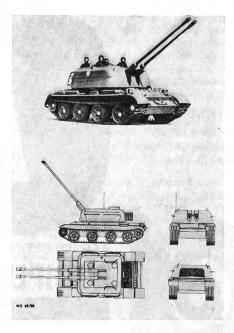
Die 57-mm-Flak ist eine vollautomatische Waffe mit einem langen, schlanken Rohr. Das Rohr S-60 der 57-mm-Kanone hat sehr gute ballistische Eigenschaften. Das Zwillingsgeschütz ist auf das abgeänderte Fahrgestell des Kampfpanzers T-54 mit nur vier Laufrollen montiert. Im Gegensatz zum T-54 ist die Fahrlucke rechteckig. Verwendet wird sie in den Flab-Batterien der Panzerregimenter. P. G.
