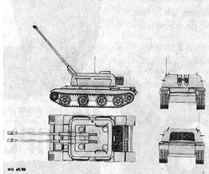
Die 57-mm-Flak ist eine vollautomatische Waffe mit einem langen, schlanken Rohr. Das Rohr S-60 der 57-mm-Kanone hat sehr gute ballistische Eigenschaften. Das Zwillingsgeschütz ist auf das abgeänderte Fahrwerk des Kampfpanzers T-54 mit nur vier Laufrollen montiert. Im Gegensatz zum T-54 ist die Fahrsluke rechteckig. Verwendet wird sie in den Flab-Batterien der Panzerregimenter. P. G.
