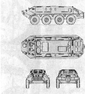
Der erstmals 1961 aufgetretene, schwimmfähige 8-Rad-Schützenpanzer BTR-60 (P) ist eine Neuentwicklung und sehr anspruchsvoll. Er hat 8-Rad-Antrieb und 8-Rad-Lenkung. Die Bordwaffe, ein in der
