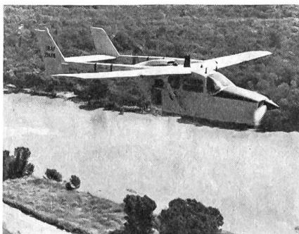
Für die psychologische Kriegsführung aus der Luft setzt die US Air Force dieses von Cessna gebaute zweimotorige Flugzeug vom Typ O-2B ein. Die Spezialausrüstung umfasst neben Lautsprecher und Verstärker auch Tonbänder und eine Vorrichtung für den Abwurf von Flugblättern. Die O-2B dient u. a. auf dem südvietnamesischen Kriegsschauplatz, wo sie sich unter den schwierigsten Verhältnissen bewährt hat.
