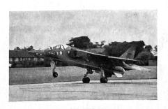
Der letzte Jaguar-Prototyp, der nach RAF-Spezifikationen gebaute zweisitzige Fortgeschrittenentrainer B.08, hat Ende August 1971 seinen Erstflug erfolgreich bestanden. Beim Bau des B.08 wurden zu einem überwiegenden Teil bereits Komponenten aus der nun im grossen Rahmen anlaufenden Serienfabrikation verwendet. Die ersten Jaguar-Kampfflugzeuge werden im Jahre 1972 an die französischen Luftstreitkräfte und an die RAF abgeliefert. K. A.
