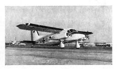
Ein Dornier-Skyservant in den Farben der deutschen Bundeswehr, die insgesamt 121 Maschinen dieses Typs erhält. Weitere vier Einheiten sind für die Flugbereitschaft der Bundesregierung bestimmt. Dieses leichte, zweimotorige STOL-Flugzeug wird bei der Luftwaffe und den Marinefliegern für Transport- und Verbindungsaufgaben (8 bis 15 Passagiere) eingesetzt. Der Skyservant zeichnet sich durch eine technisch einfache Konstruktion aus und kann auch mit Schwimmern oder Skiern ausgestattet werden. K. A.
