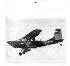
Die erste Hunderterserie des leichten Beobachtungs- und Aufklärungsflugzeuges Siai Marchetti SM.1019 steht zurzeit im Bau. Die zweisitzige SM.1019 ist mit einer Allison-Propellerturbine ausgerüstet, die es erlaubt, auf Meereshöhe mit 50 Metern Start- und Landefläche auszukommen. Je nach Einsatz können unter den Flügeln verschiedene Aussenlasten transportiert Werden. K. A.
