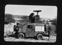
Luftraumüberwachungs- und Feuerleitsystem für Rohrwaffen und Raketen
