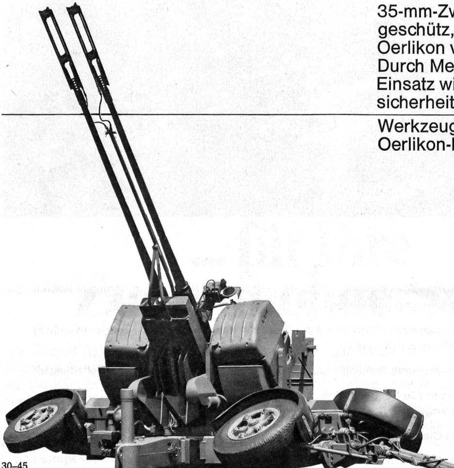
35-mm-Zwillings-Fliegerabwehr-geschütz, ausgerüstet mit einer Oerlikon  $v_0$ -Messeinrichtung. Durch Messung der  $v_0$  im taktischen Einsatz wird eine optimale Treffsicherheit gewährleistet.
