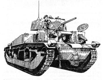
Schwerer britischer Panzer «Valentin», 16 t: 1 Kanone 5.7 cm, Vo 910 m/Sek: 2 Mg; Panzerung: Front 6 cm; Geschwindigkeit: 25 km/h; Fahrbereich: 150 km; Besatzung: 4 Mann; Munition: Kanone 60 Schuss, Mg 3000 Schuss.
