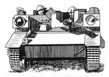
Britisches Panzergrenadierfahrzeug «Bren-Carrier». Panzerung: 11 mm; Gewicht: 2 t; Bewaffnung: 1 Mg; Besatzung: 1 Fahrer, 1 Schütze, 5 Panzer-grenadiere; Aktionsradius: 180 km; Geschwindigkeit 45 km/h; oben offen.
