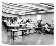
Die bei Saab für die Bekämpfung von Land- und Seezielen entwickelte Luft-Boden-Lenkwaffe RBO 5 A steht nun für die schwedischen Luftstreitkräfte in Serien-produktion (Bild). Die mit Überschallgeschwindigkeit fliegende Rakete wird vom Piloten über Funk ins Ziel gesteuert. Eine spätere Version soll ein von Saab entworfenes Fernsehlenksystem erhalten. Der Flugkörper wiegt gefechtsbereit 305 kg und hat eine Länge von 3,6 m. Er wird u. a. die Kampfflugzeuge AJ 37 Viggen bewaffnen.
