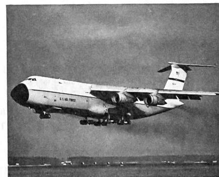
Das zurzeit grösste Flugzeug der Welt, die Lockheed C-5 A Galaxy, wird nun vom Military Airlift Command der US Air Force regelmässig für Nachschubflüge zwischen den USA und dem deutschen Rhein-Main-Flughafen eingesetzt. Die C-5 A Galaxy ist 74,95 m lang und verfügt über eine Spannweite von 67,85 m. Sie kann bis zu 120 t Fracht transportieren. K. A.
