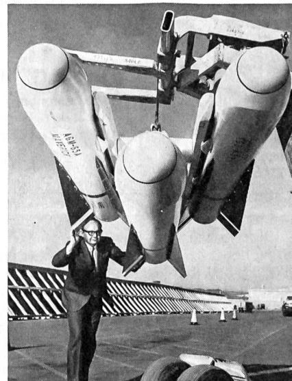
Maverick heißt eine 2,4 km lange und rund 225 kg schwere, ferngesteuerte Luft-Boden-Lenkwaffe, die gegenwärtig bei der Firma Hughes im Auftrage der USAF entwickelt wird. Erste Probeabschüsse zeigten gute Resultate, und es darf angenommen werden, dass dieser Flugkörper in die Serienproduktion geht. Für die Bekämpfung von «harten» Erdzielen entworfen, soll die Maverick vor allem die Phantom- und Corsair-Flugzeuge der USAF ausrüsten. K. A.
