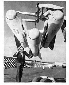
Maverick heisst eine 2,4 km lange und rund 225 kg schwere, fernsehgesteuerte Luft-Boden-Lenkwaffe, die gegenwärtig bei der Firma Hughes im Auftrage der USAF entwickelt wird. Erste Probeabschüsse zeitigten gute Resultate, und es darf angenommen werden, dass dieser Flugkörper in die Serienproduktion geht. Für die Bekämpfung von «harten» Erdzielen entworfen, soll die Maverick vor allem die Phantom- und Corsair-Flugzeuge der USAF ausrüsten.
