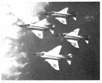
Eine Doppelpatrouille F-4 J Phantoms der Fighter Squadron 31 von der «USS Saratoga» im engen Verbandsflug hoch über dem Mittelmeer. Diese Phantom kann als Abfangjäger 6 Sparrow-III-Luft-Luft-Raketen und 4 Infrarot-Sidewinder-Luft-Luft-Raketen mitführen.
