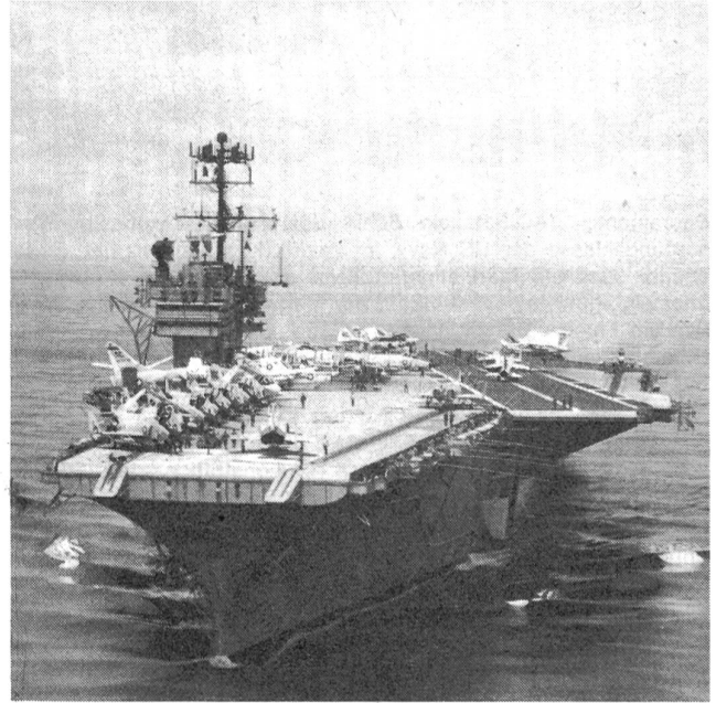
Die «USS Saratoga» auf Fahrt im Mittelmeer. Die vier Katapulte sind gut sichtbar; zwei befinden sich auf dem Vorderdeck und zwei mittschiffs in der dunkel gefärbten Landepiste, die 216 Meter lang ist und zur Hauptachse des Schiffes eine Abweichung von 8° aufweist.
