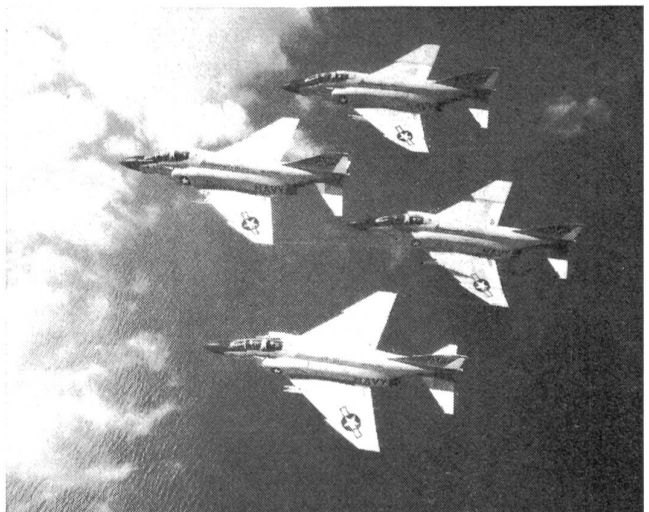
Eine Doppelpatrouille F-4 J Phantoms der Fighter Squadron 31 von der «USS Saratoga» im engen Verbandsflug hoch über dem Mittelmeer. Diese Phantom kann als Abfangjäger 6 Sparrow-III-Luft-Luft-Raketen und 4 Infrarot-Side-winder-Luft-Luft-Raketen mitführen.
