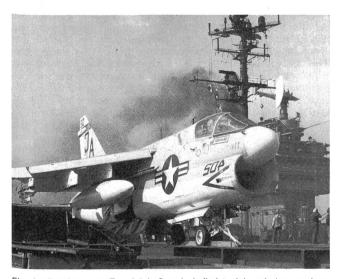
Ein Jagdbomber vom Typ A-7 A Corsair befindet sich auf dem vorderen Backbordkatapult der «USS Saratoga». Gut sichtbar ist die Befestigung des Katapultschuhs am Bugrad dieses für die Schweizer Luftwaffe zusammen mit dem italienischen Fiat-Jagdbomber in Auswahl stehenden Flugzeuges. An einer der drei Flügelaussenstationen ist ein Zusatztank aufgehängt.
