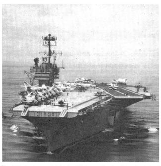
Die «USS Saratoga» auf Fahrt im Mittelmeer. Die vier Katapulte sind gut sichtbar; zwei befinden sich auf dem Vorderdeck und zwei mittschiffs in der dunkel gefärbten Landepiste, die 216 Meter lang ist und zur Hauptachse des Schiffes eine Abweichung von 8° aufweist.
